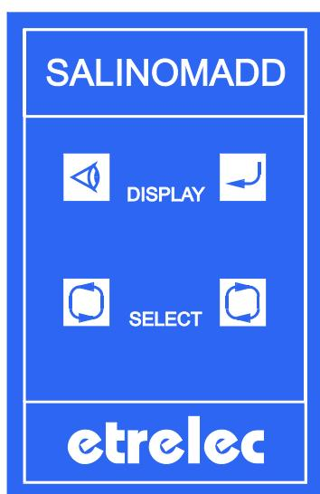
El SALINOMADD dispone de 4 teclas de funciones, en la parte delantera del aparato.
