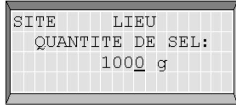
Si la distancia es grande, la dilución será importante y el aumento de la salinidad será pequeña en el punto a medir. Para obtener buenos resultados, se necesita solamente un aumento de la salinidad del 10% o al menos 15 mgr./l, con relación a la salinidad base del agua. La cantidad de sal depositada debe de ser conocida con precisión porque servirá para el cálculo del caudal. La capacidad del SALINOMADD permite una inyección mínima de 1 gr. y máxima de 1000 gr.
