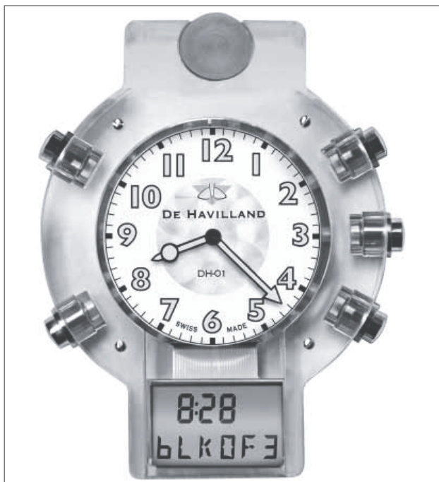
Fig. 4 : Démonstrateur de la montre. La molette supérieure simule le fonctionnement de la lunette. Les boutons poussoirs sont sans liaison mécanique avec le mouvement. Il existe une liaison entre le LCD et le mouvement.
