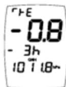
La pression affichée est celle d'il y a 3 heures, soit la pression mesurée à 8h. L'instrument compare la dernière pression mesurée à l'heure pile (ici, celle de 11h, 1011.0) avec la pression d'il y a 3h et en affiche la différence. On constate que la pression a chuté de 0.8hPa en 3 heures.
