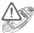
**Si l'instrument reste allumé en permanence, la pile se décharge plus rapidement, pensez-y !**
