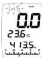
Lorsque l'instrument est éteint, une **courte pression du bouton**
