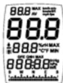
Sert à vérifier si tous les segments du LCD fonctionnent. Lorsque l'instrument est éteint, maintenez simultanément appuyés les 3 boutons pendant 2 secondes, tous les segments s'allument (voir ci-contre). Pour arrêter l'instrument, maintenez
