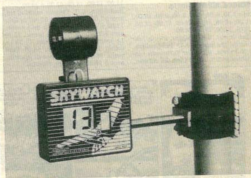
Le Skywatch, muni de son hélice de mesure, affiche la vitesse en km/h. Il peut être fixé sans problème aux tubes des ailes delta.
