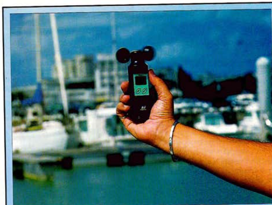
L'un des avantages de l'anémomètre à coupelles est qu'il n'est pas nécessaire d'être face au vent pour l'utiliser. En revanche, ses godets sont fragiles.
