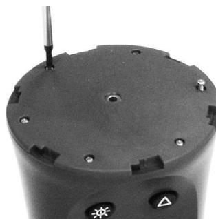
2. Soulevez délicatement le support puis remplacez-le par celui de rechange. Attention : le joint d'étanchéité doit rester à sa place.
