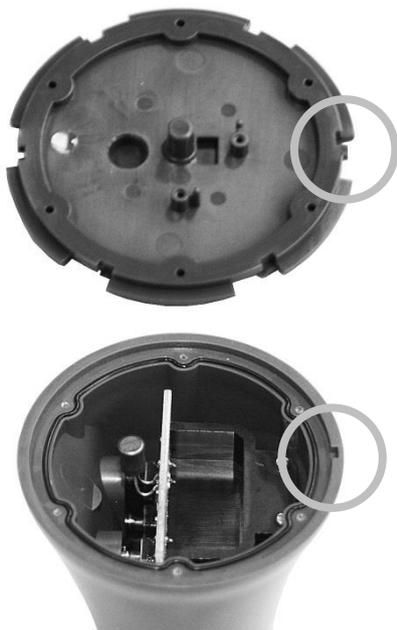
3. Revissez soigneusement les 6 vis et vissez l'hélice de rechange en vérifiant que les rondelles soient insérées dans le cylindre de l'hélice.
